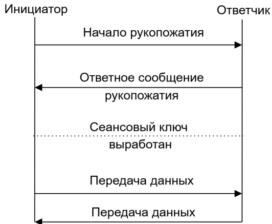
Рис. 1: Общее строение протокола Wireguard; версия без Cookie
