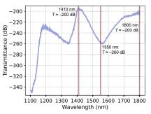
Пропускание системы из пассивных компонентов защиты
