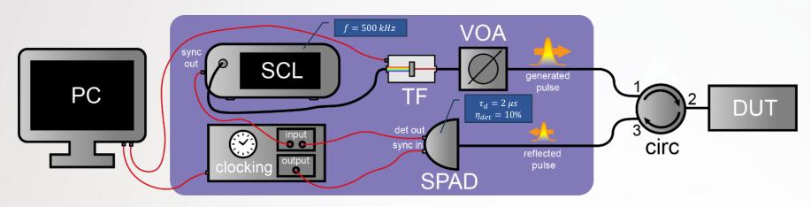
SCL - суперконтинуумный пикосекундный лазер, TF - перестраиваемый фильтр, VOA - перестраиваемый аттенюатор, SPAD - лавинный фотодиод на базе InGaAs, CIRC - волоконный циркулятор
